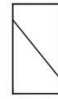
Tipo 4 Fractura diagonal sin fisuras a través de los extremos; golpee suavemente con un martillo para distinguirla del Tipo 1
