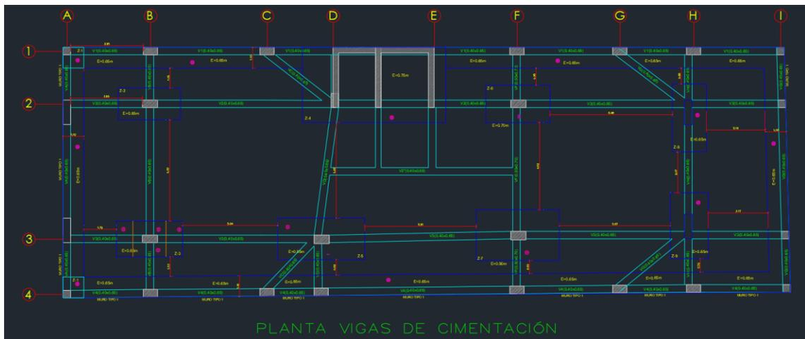
Ilustración 24. planta vigas de cimentación (fuente: planos estructurales Edificio Fourvière)
