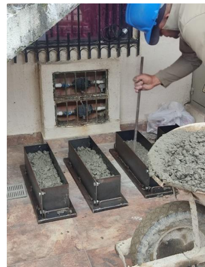
Figura 36. Muestras, vigas de concreto
