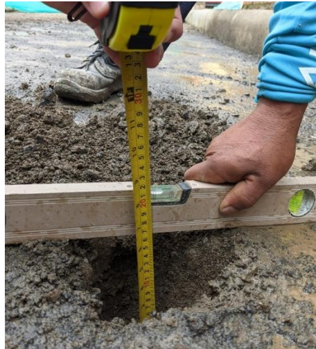
Figura 30. Medición de espesor en el apique No.1
