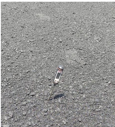
Figura 75. Temperatura de compactación (85.0 ° C)
