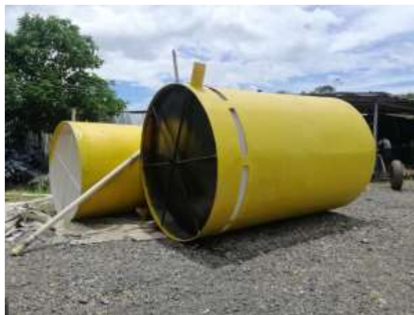
Ilustración 12. Tanque filtro percolador con la tubería interna instalada. Fuente: Propia
