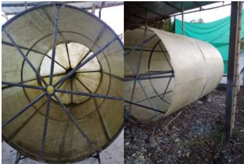
Ilustración 8: Estructura metálica de soporte para sedimentador. Fuente: Propia
