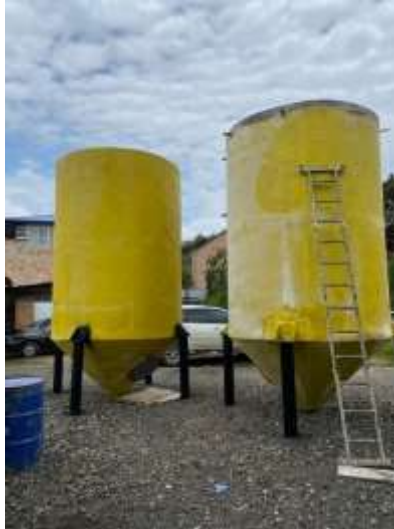
Ilustración 13. Sedimentadores primario y secundario completos para la instalación en campo. Fuente: Propia
