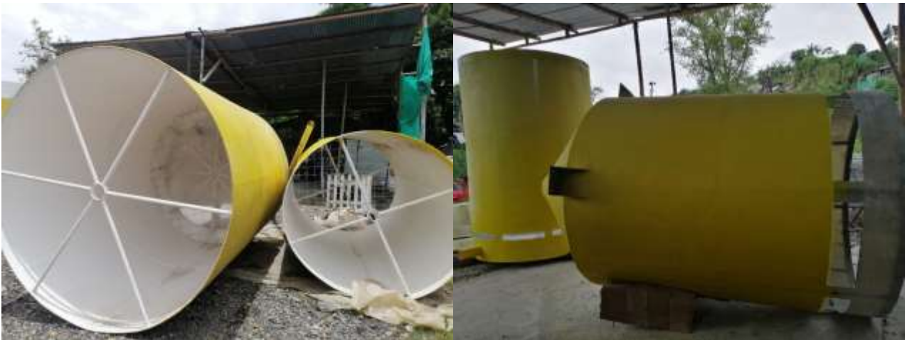
Ilustración 10 Tanques sellados interna y externamente. Colorante amarillo. Fuente: Propia.
