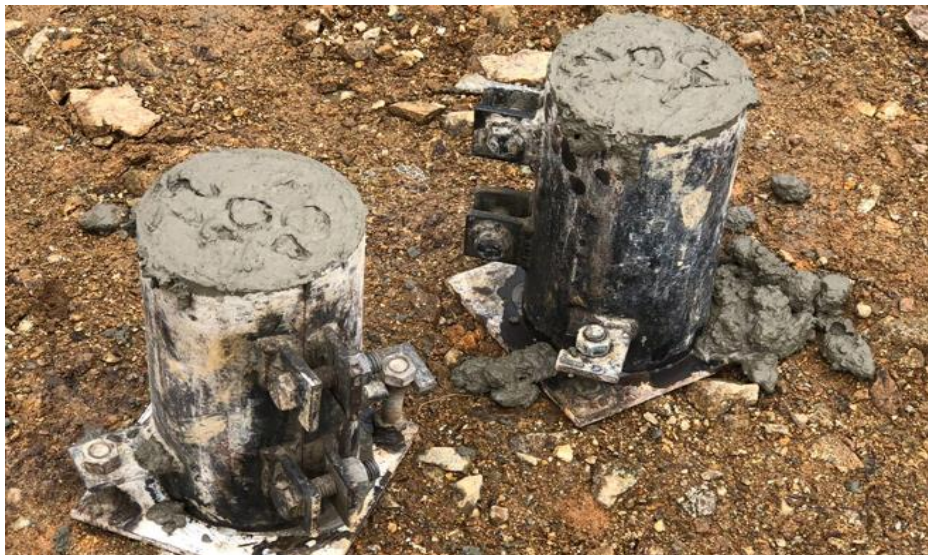
Imagen 24. Toma de muestras de concreto para ensayos de resistencia. Fuente: Propia
