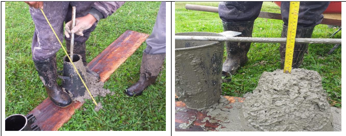
Figura 19. Verificación asentamiento del concreto
