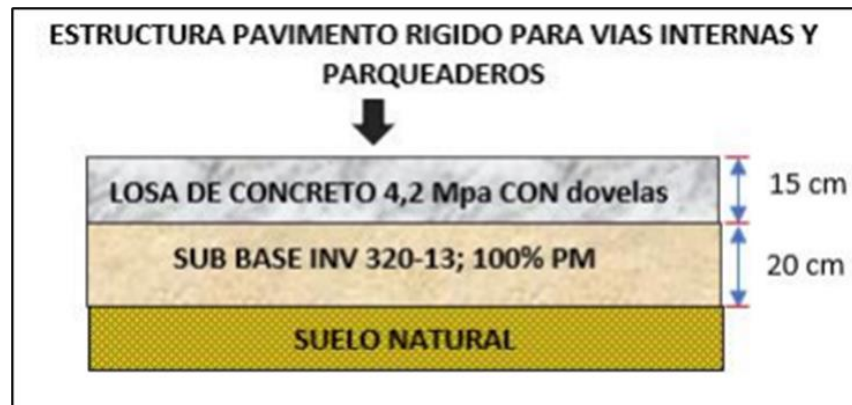
Ilustración 58. Estructura de pavimento Fuente: Elaboración propia
