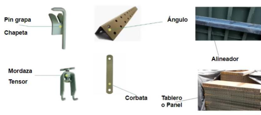
Ilustración 7. Elementos que conforman la formaleta metálica
