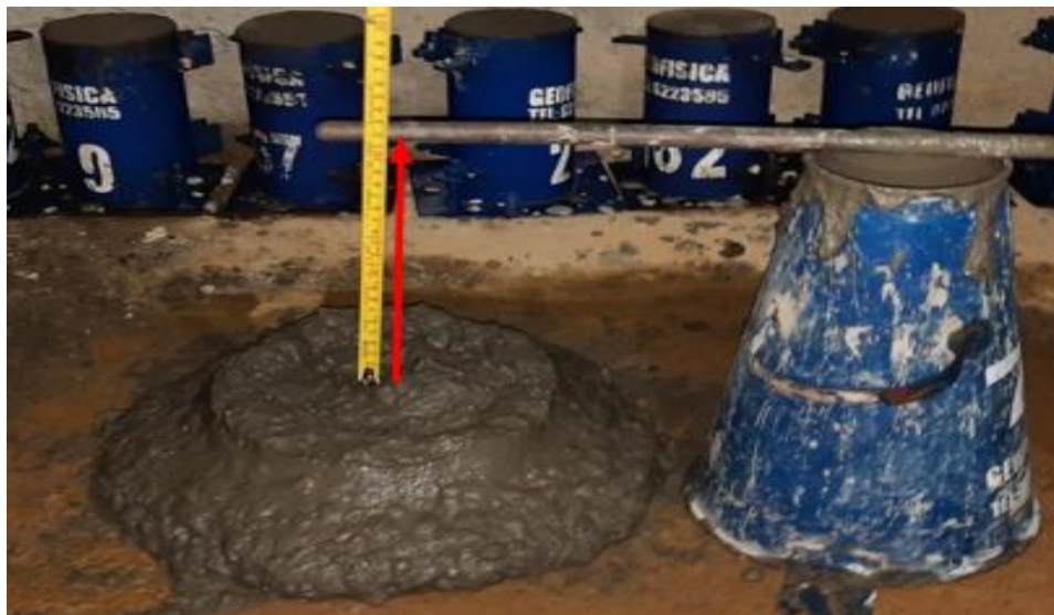
Figura 28. Prueba de consistencia del concreto fresco.
