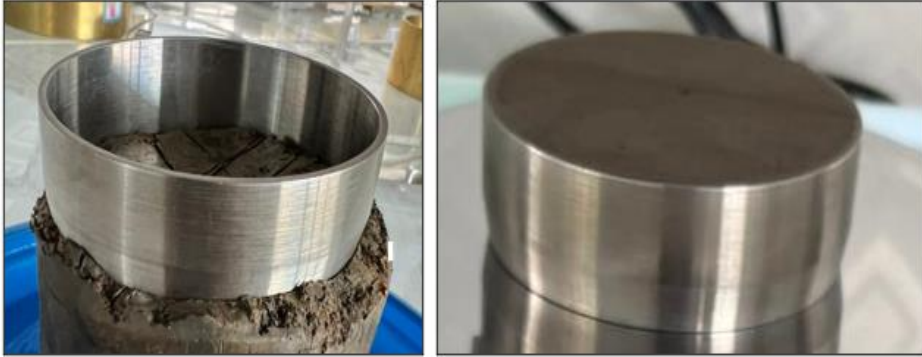
Imagen 31. Tallado de muestra para consolidación
