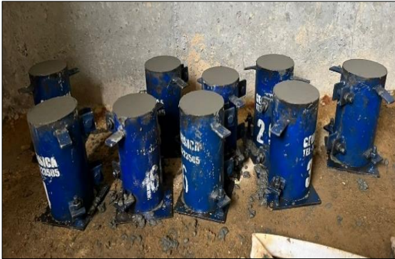
Imagen 9. Elaboración de 9 cilindros de 4" en concreto para obra Gracol S.A.S.
