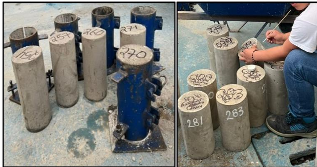
Imagen 10. Remoción de moldes y marcación de cilindros
