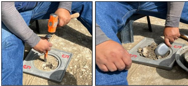
Imagen 15. Elaboración de hueco para ensayo de densidad
