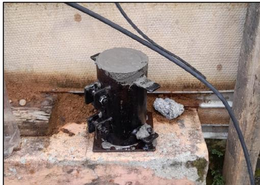
*Ilustración 59, cilindro número 1 muestra de concreto de la fundición, Fuente: Elaboración propia.*
