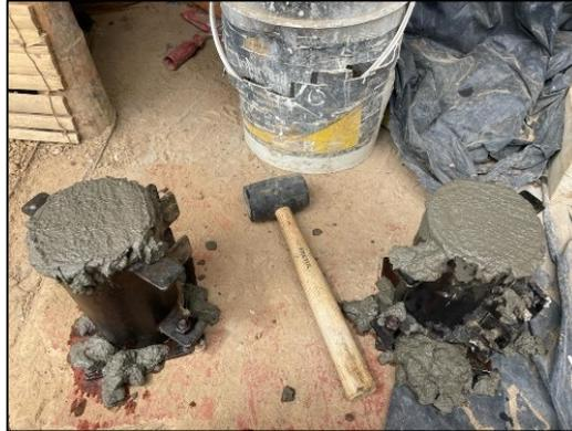
*Ilustración 114, Cilindros de concreto, Fuente Elaboración propia.*
