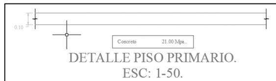
*Ilustración 94, Detalle piso primario, Fuente: Constructora Open House.*
