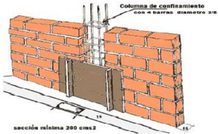
Figura 5. Instalación de columnetas.
