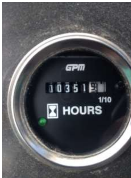
Ilustración 12. Contador de la máquina, control horas de uso.
