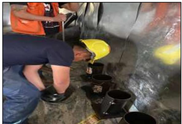
**Foto 45** Cilindros para obtención de muestras
