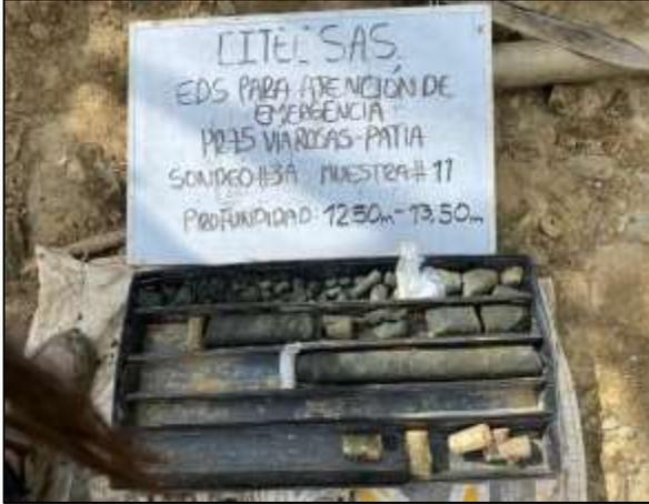
**Foto 74** Núcleos extraídos en el ensayo
