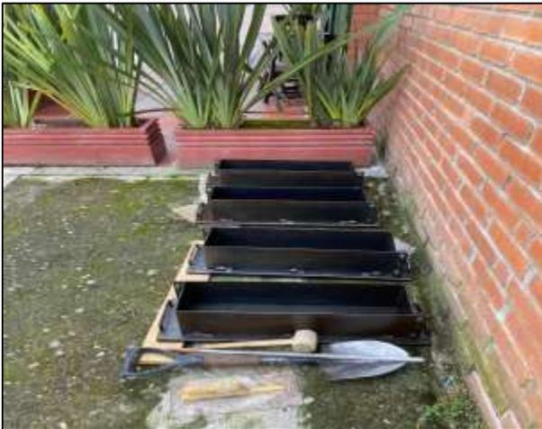
**Foto 42** Vigas para obtención de muestras
