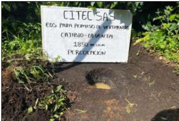
**Foto 34** Ensayo de percolación
