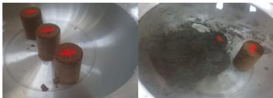
Ilustración 19. Estabilidad hidráulica Suelo 2 – Pueblillo – Mezcla óptima (Adición de 5% de CBC y Concentración Molar de 2M) con 7 días de curado.
