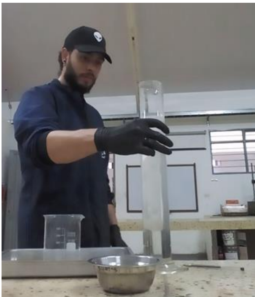
Ilustración 9. Preparación del activador alcalino
