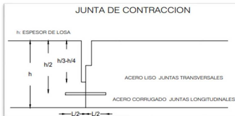
Ilustración 27. Ilustración del corte de la junta de contracción Fuente: Elaboración compañía GESCO S.A.S
