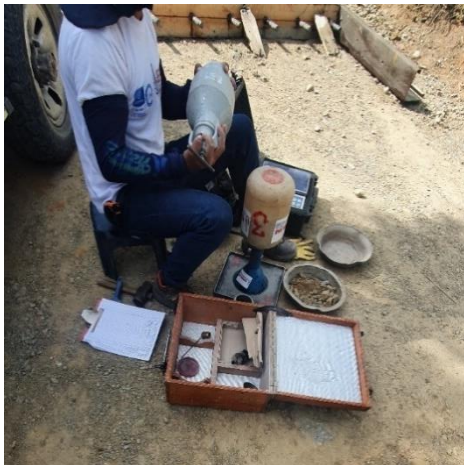
Ilustración 37. Toma de muestra para el ensayo de densidades por parte de la compañía GEOFISICA S.A.S
