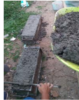
Ilustración 74. Toma de muestras de vigas de concreto.
