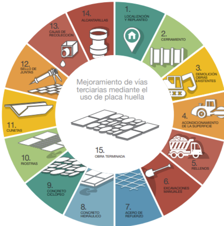
Ilustración 133. Esquema del proceso constructivo de la placa huella Fuente: Departamento Nacional de Planeación
