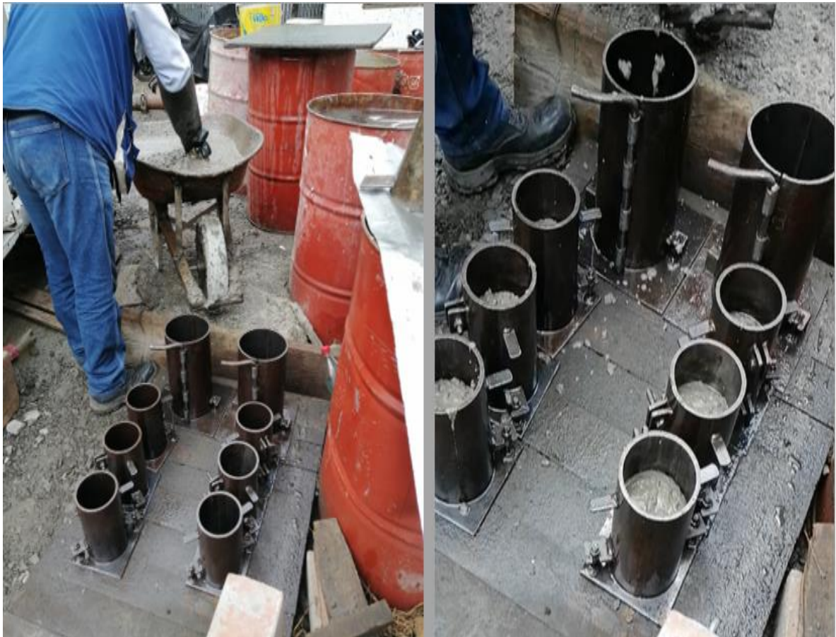
Ilustración 13. Elaboración de cilindros de concreto
