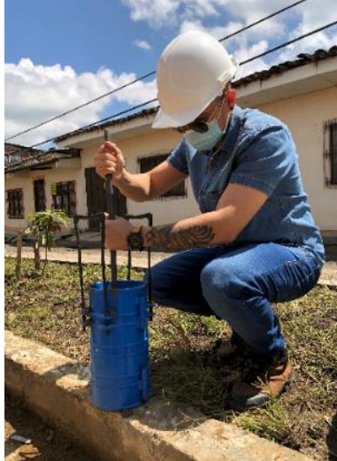
Ilustración 40. Elaboración de cilindros de concreto
