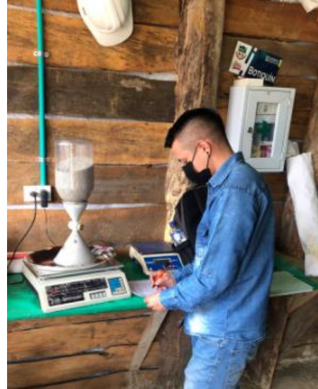
Ilustración 72. Ensayo de densidad, método cono y arena,
