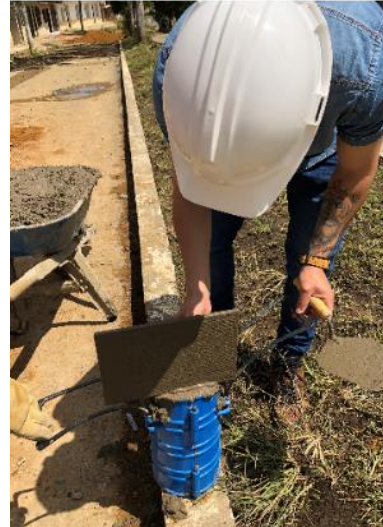
Ilustración 39. Elaboración de cilindros de concreto 2
