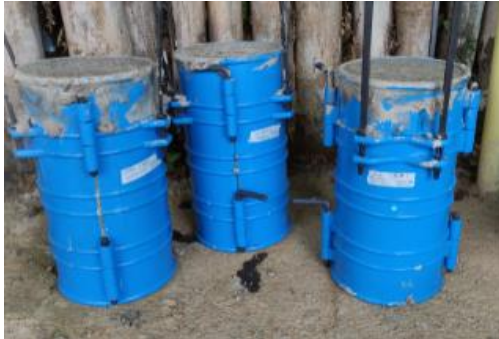
Ilustración 43. Cilindros de concreto
