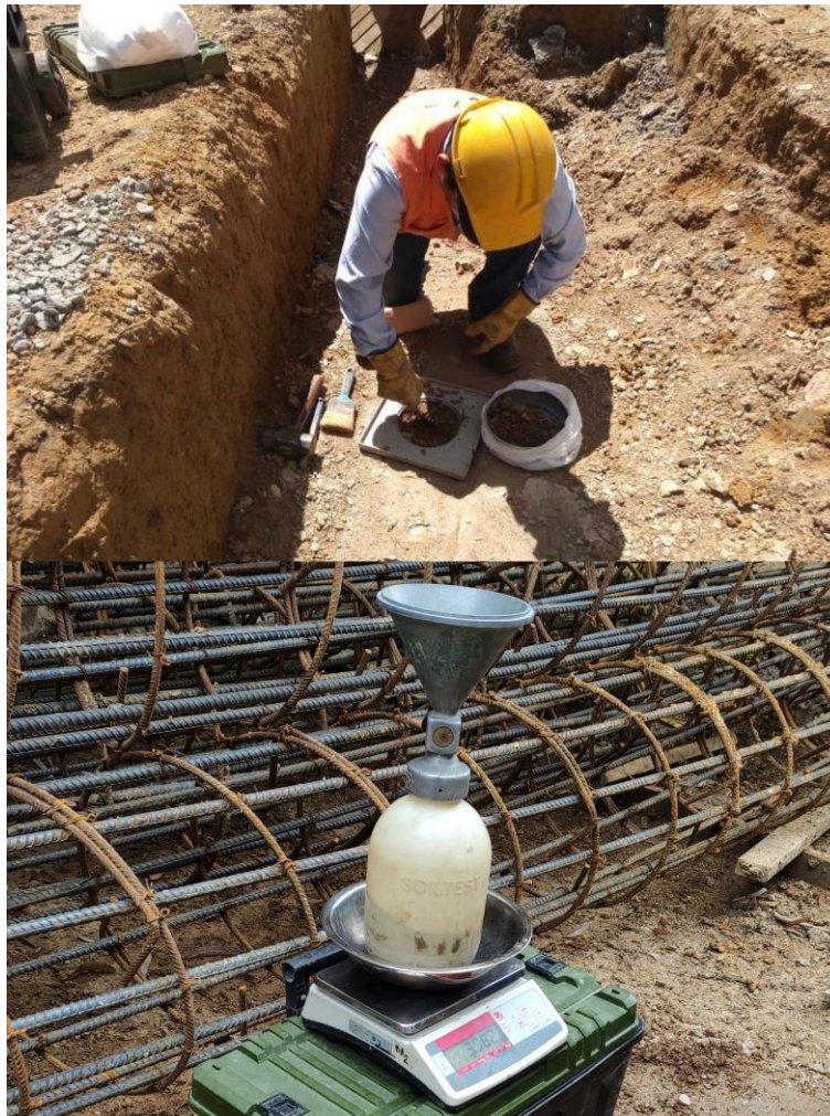
Ilustración 35. Ensayo Cono de Arena para determinación densidad In Situ
