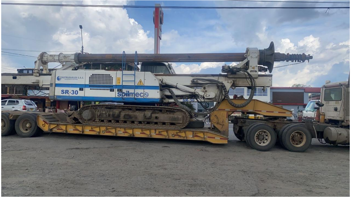
Ilustración 46. Piloteadora SOILMEC SR-30 en camino hacia la obra
