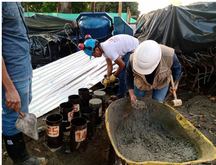
Ilustración 41. Toma de muestras de concreto premezclado
