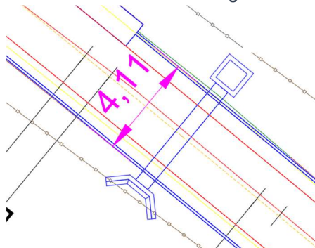
Ilustración 60. Medición de longitud tuberías
