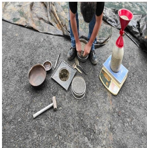
Ilustración 20. Toma de densidades de la capa de subbase
