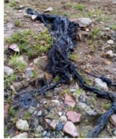
TAPONAMIENTO DE ALCANTARILLADO RESIDUAL QUE SE EXTRAJO DE LA RECAMARA #1.
