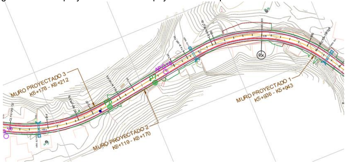
Figura 40 Muros proyectados tramo Popayán - Fondas planta
