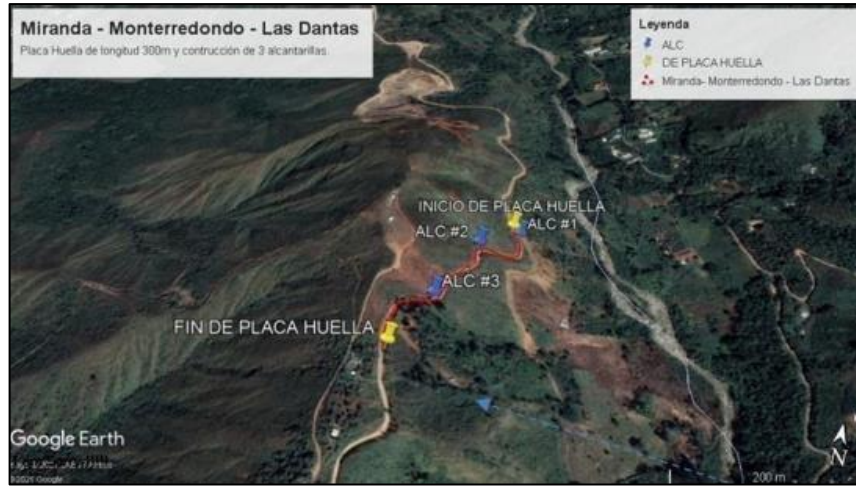
Figura 22. Localización tramo Monterredondo - Miranda
