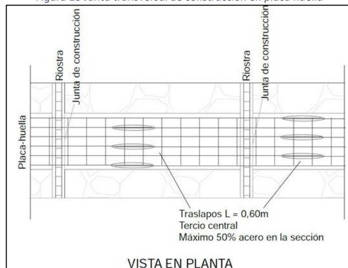
Figura 15 Junta transversal de construcción en placa huella
