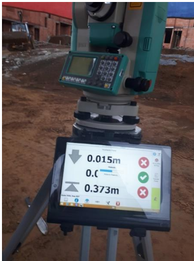
Imagen 37 Comisión de topografía para levantamiento de puntos con estación total
