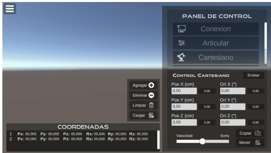
Figura 3.21.: Diseño del control cartesiano.
