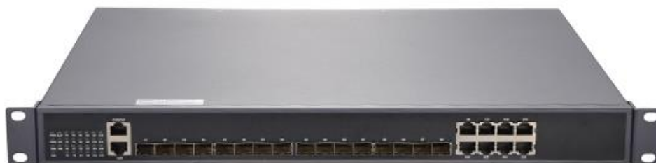
Figura 1.5 Terminal de línea óptica [16].
