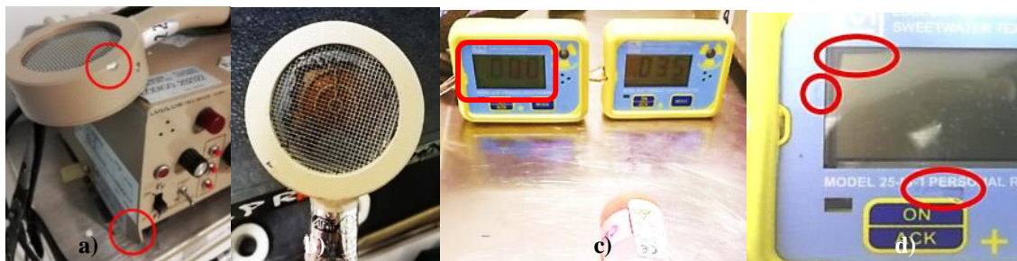
Figura 4.20 a) Averías después de calibración detector de radiación de manos y pies marca Ludlum modelo 177, b) pancake rota, c) detección de fallo en mediciones antes del envío a calibración, d) desperfectos en pantalla y botones de operación para un dosímetro de lectura directa.
