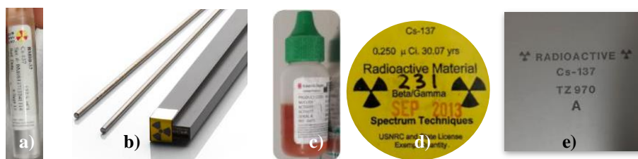
Figura 2.2 Tipos de fuentes radiactivas a) dedal, b) lineal 4 , c) gotero, d) puntual, e) plana (losa).
