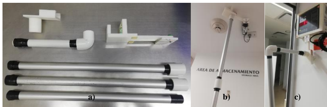
Figura 3.8. Montaje modular para medición de exposición radiactiva a) Accesorio para detectores fijos, b) mediciones en posición horizontal, c) mediciones en posición vertical
