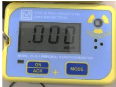
Figura 3.5. Dosímetro de lectura directa marca Ludlum, modelo 25-IS-1
