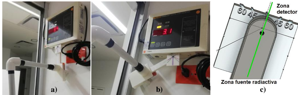
Figura 3.11 Montaje experimental para medición de exposición radiactiva direccional. a) medidas realizadas en la ubicación 0°. b) medida realizada con una angulación de 60°. c) pieza modular giratoria que permite ajustar los ángulos de medición.
