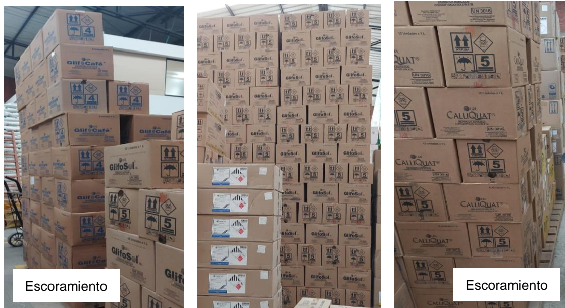
Figura 33. Escoramiento en el cruzamiento de las cajas de proveedores UPL.
