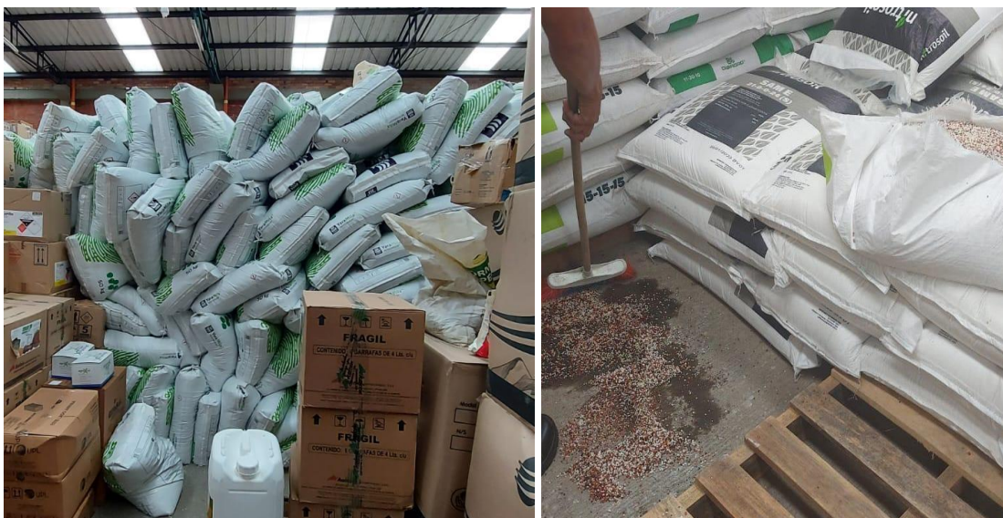
Figura 23. Deslizamiento de bultos.
