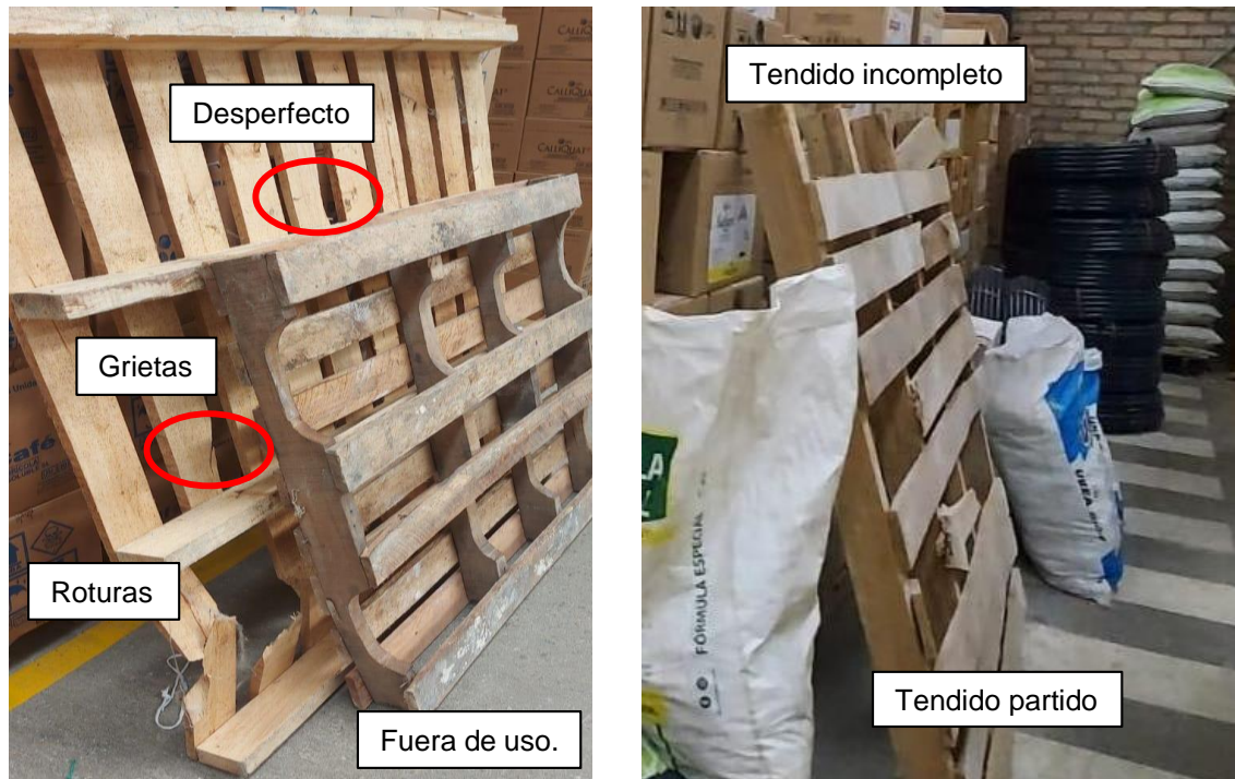
Figura 26. Estibas en mal estado y fuera de uso.
