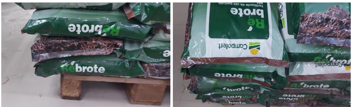
Figura 38. Desbordamiento en cruzamiento de pacas.
