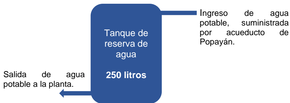
Figura 1. Ilustración del tanque de agua
