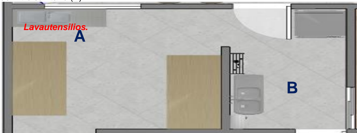
Figura 20. Implementación de un lava utensilios (A) en el área de elaboración y adecuación del filtro sanitario (B)
