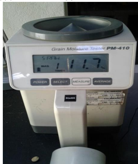
Figura 3. Medidor de humedad KETT PM-450
