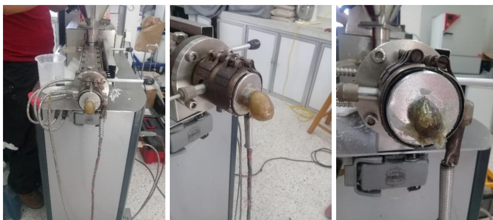
Figura 11. Material denso en la boquilla de extrusión
