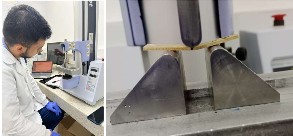
Figura 14. Prueba de flexión en material compuesto
