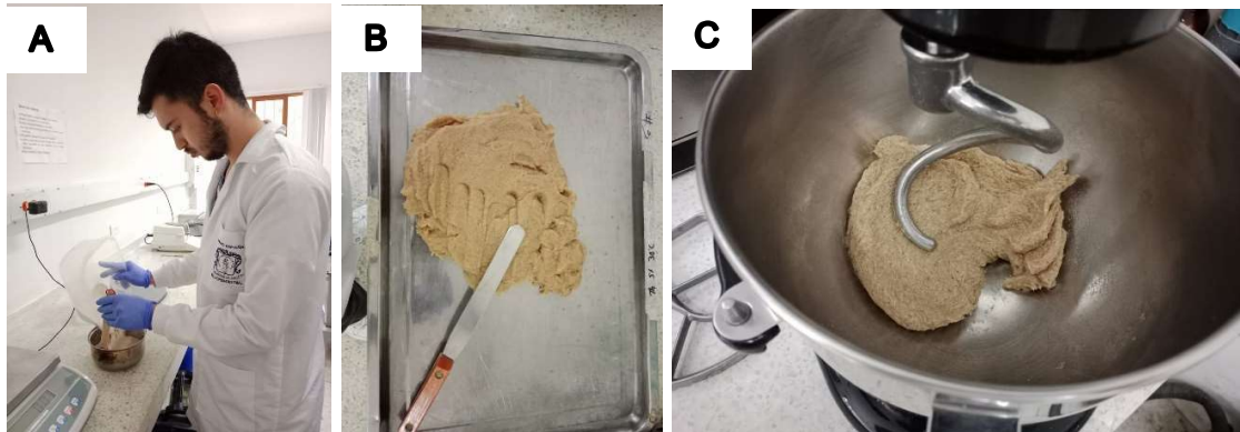
A: Mezcla de componentes para gelatinizar B: Gel de afrecho de yuca C: Mezcla de gel de afrecho de yuca y fibra de fique.
