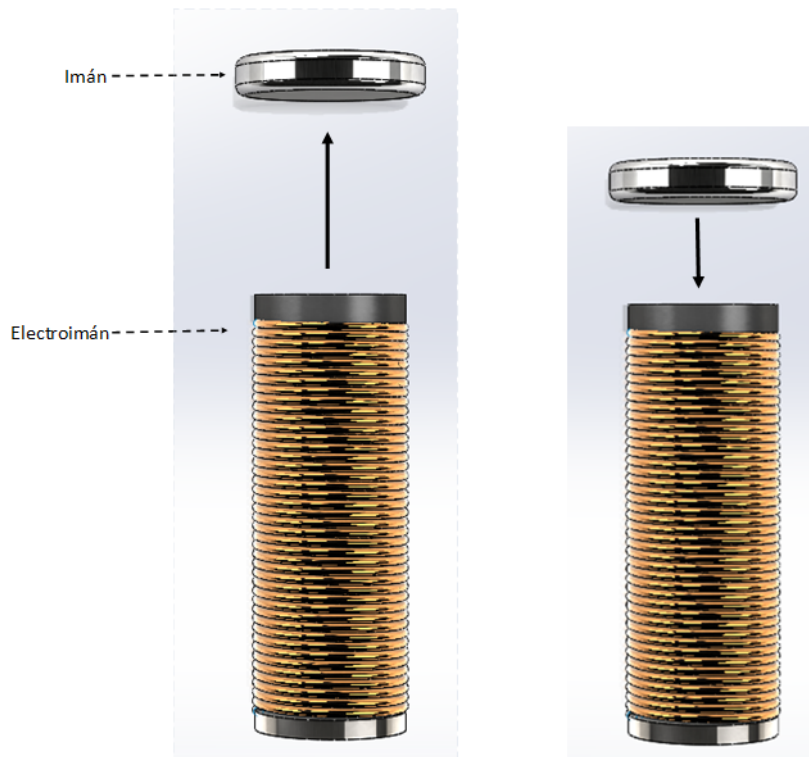
Figura 4.12: Interacción entre imán de neodimio y electroimán. Fuente: Elaboración Propia.
