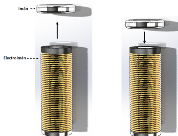
Figura 4.3: Interacción entre imán de neodimio y electroimán. Fuente: Elaboración Propia.
