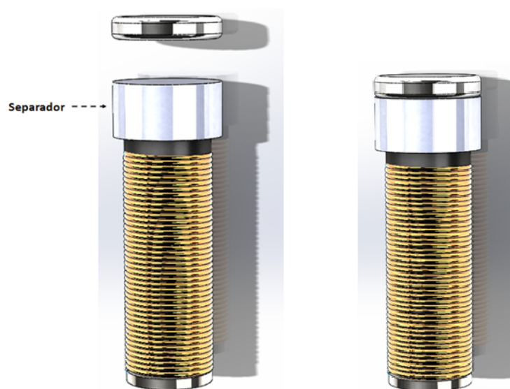
Figura 4.4: Función de la pieza separador. Fuente: Elaboración Propia.
