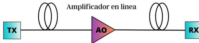
Figura 1.17: Amplificador en Línea. Adaptada de [38].
