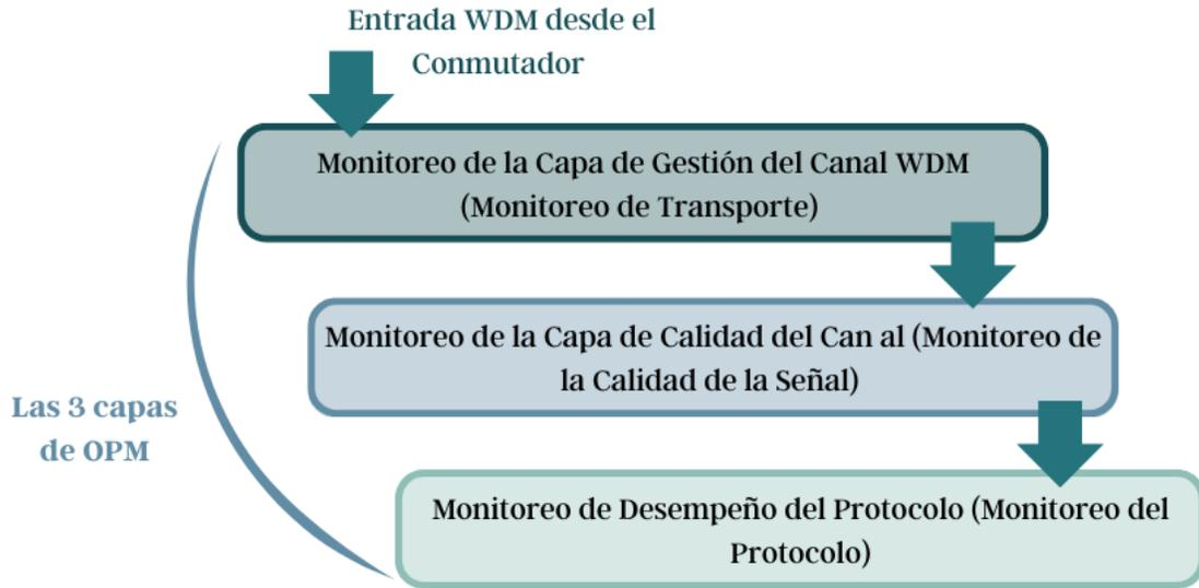
Figura 1.33: Niveles del Monitoreo del Desempeño Óptico (OPM). Adaptada de [61].
