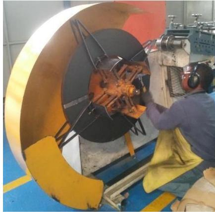
*Figura 4: Máquina de desenrollado y aplanado.*
