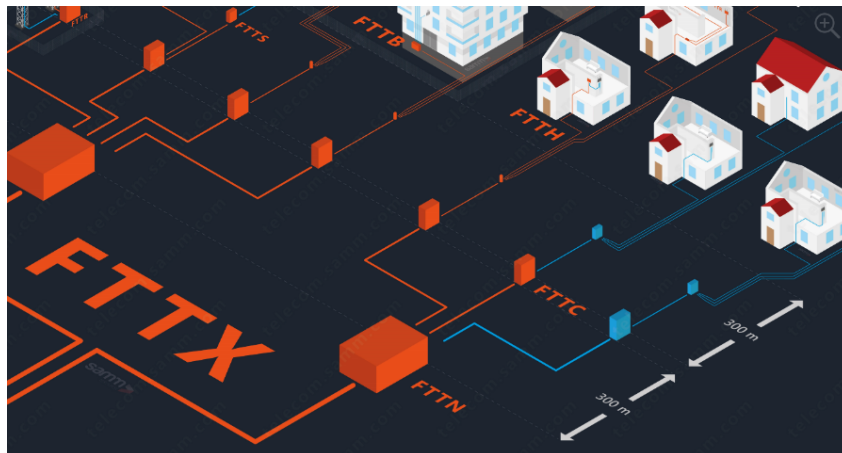
Figura 1.13: Arquitecturas FTTN, FTTC/K, FTTH, FTTB. Tomado de [42].
