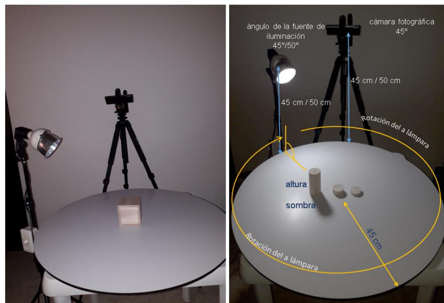
Figura 3.8. Guía general de formación de sombras de una figura al rotar. (creación propia).
