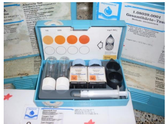
Figura N° 14: Equipos de precisión para análisis de calidad de aguas naturales.
