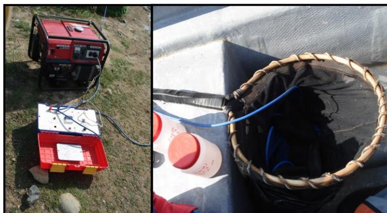
Figura N° 12: Equipo de electropesca utilizado para la captura de peces.
