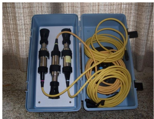
Figura N° 13: Equipos potenciométricos y de precisión para análisis de calidad de aguas naturales.
