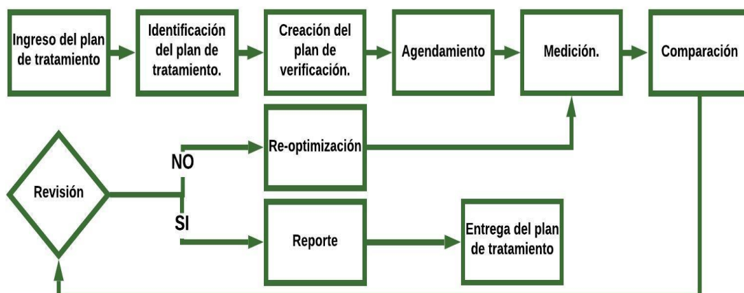
Figura 4.9: Flujo de trabajo para los controles de calidad paciente específico realizados en los tratamientos de radioterapia con técnicas IMRT y VMAT.
