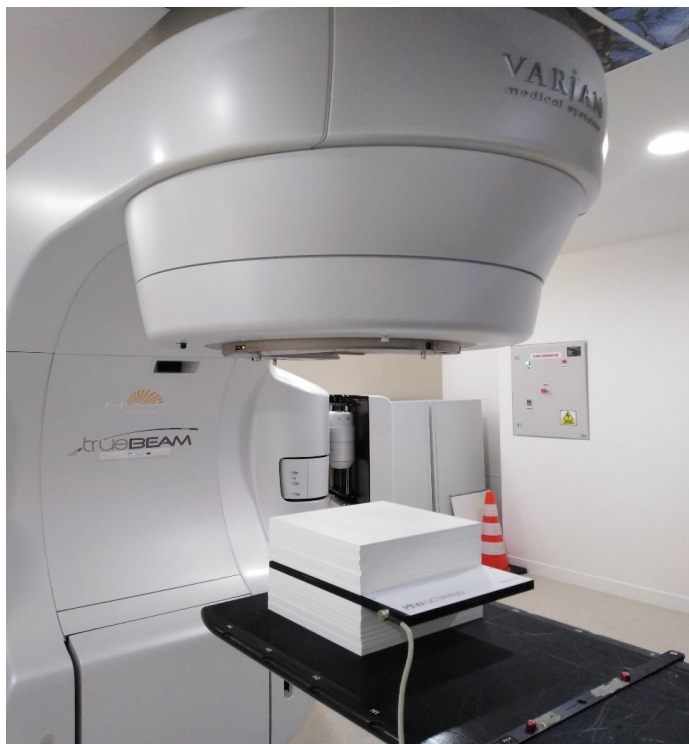
Figura 4.8: Acelerador Lineal TrueBeam del servicio de Radioterapia de la Fundación Valle del Lili. Arreglo Octavius Detector 729 montado para realizar controles de calidad paciente específico.
