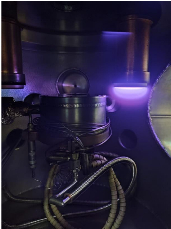
Figura 6. Vista interna de sputtering D.C con plasma encendido. Fotografía tomada del sistema sputtering D.C, perteneciente al grupo de física de bajas temperaturas de la Universidad del Cauca. Fuente: Elaboración propia.
