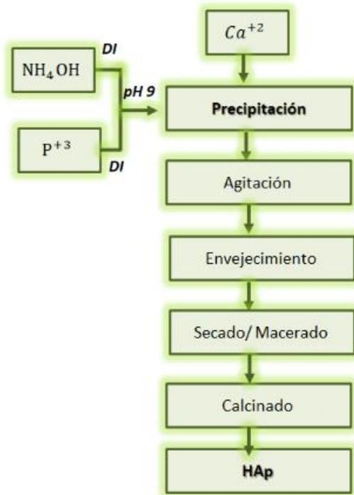
Figura 2.4. Diagrama de la síntesis de HAp
