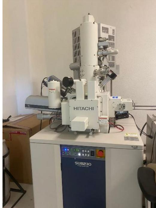
2.12 Microscopio electrónico de barrido Hitachi SU8230.
