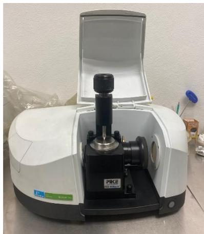
Figura 2.9 Espectrómetro de infrarrojo Perkin Elmer Spectrum Two.
