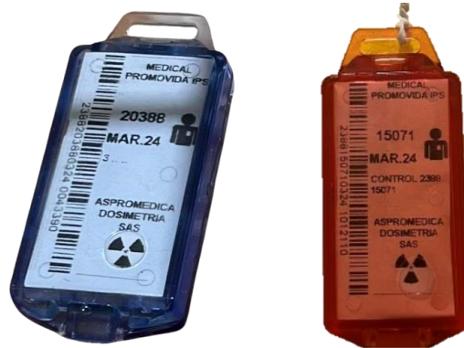
Figura 6.1. Dosímetros termoluminiscentes UD-802 usados para cuantificar la radiación
