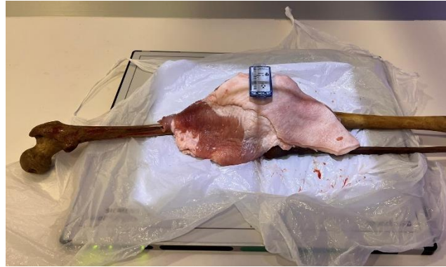
Figura 6.10. Fabricación y resultado de la elaboración del bio-modelo de rodilla humana
