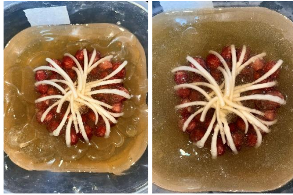
Figura 6.6. Proceso de fabricación y resultado de la elaboración del bio-modelo de mama humana
