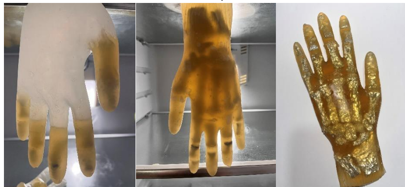
Figura 6.5. Proceso de fabricación y resultado de la elaboración del bio-modelo de mano humana
