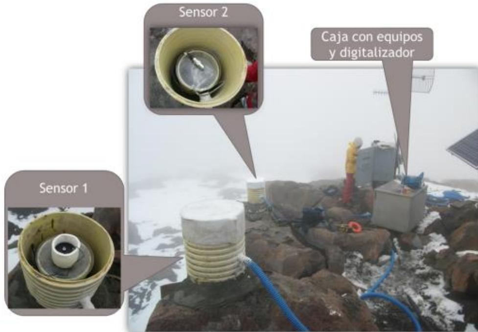
**Figura 10.** Instalación estación ACOLM VNR con par de sensores acústicos, caja con instrumentación y digitalizador
