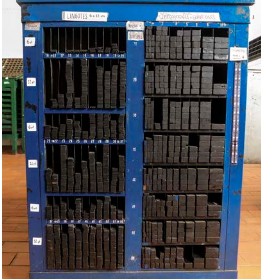
Rama o Mueble de lingotes e imposiciones de madera donde se observa el grabado de los números que indican el tamaño del material de blancos.
