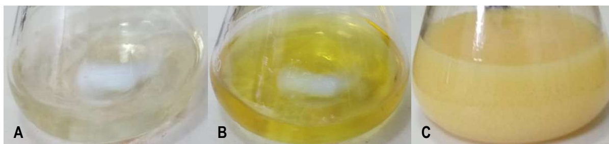
Anexo 8. Síntesis de complejo 16c tras A. Disolución de 9 en MeOH caliente, B. Adición de solución acuosa de 13 a la solución anterior y C. Adición de solución acuosa de \text{NaClO}_4 \cdot \text{H}_2\text{O} a la mezcla anterior y formación de precipitado.
