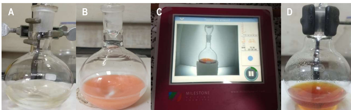
Imagen 13. Mezcla de reacción para la síntesis de 10: A. Tras adición de 4 y 1, B. Tras 2 h de agitación a temperatura ambiente, C. Tras adición de 5 mL de \text{NH}_4\text{OH} al 30% y calentamiento microondas con \text{TI}= 12 min y \text{PMO}= 70 W en Equipo Milestone FlexiWave y D. Tras cumplimiento del \text{TI} a la \text{PMO} programada.
