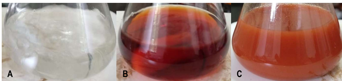
Anexo 6. Síntesis de complejo 16a tras A. Disolución de 9 en MeOH caliente, B. Adición de solución acuosa de 11 a la solución anterior y C. Adición de solución acuosa de \text{NaClO}_4 \cdot \text{H}_2\text{O} a la mezcla anterior y formación de precipitado.
