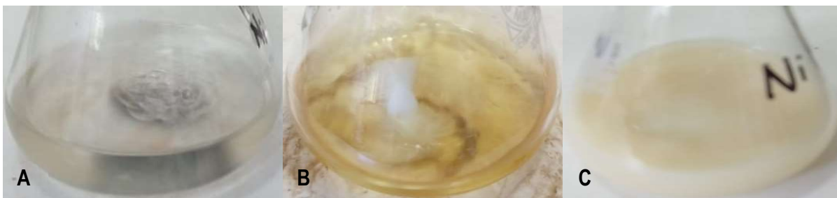
Anexo 13. Síntesis de complejo 17d tras A. Disolución de 10 en MeOH caliente, B. Adición de solución acuosa de 14 a la solución anterior y C. Adición de solución acuosa de \text{NaClO}_4 \cdot \text{H}_2\text{O} a la mezcla anterior y formación de precipitado.
