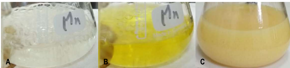
Anexo 4. Síntesis de complejo 15c tras A. Disolución de 8 en MeOH caliente, B. Adición de solución acuosa de 13 a la solución anterior y C. Adición de solución acuosa de \text{NaClO}_4 \cdot \text{H}_2\text{O} a la mezcla anterior y formación de precipitado.
