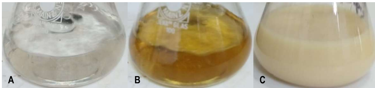
Anexo 5. Síntesis de complejo 15d tras A. Disolución de 8 en MeOH caliente, B. Adición de solución acuosa de 14 a la solución anterior y C. Adición de solución acuosa de \text{NaClO}_4 \cdot \text{H}_2\text{O} a la mezcla anterior y formación de precipitado.
