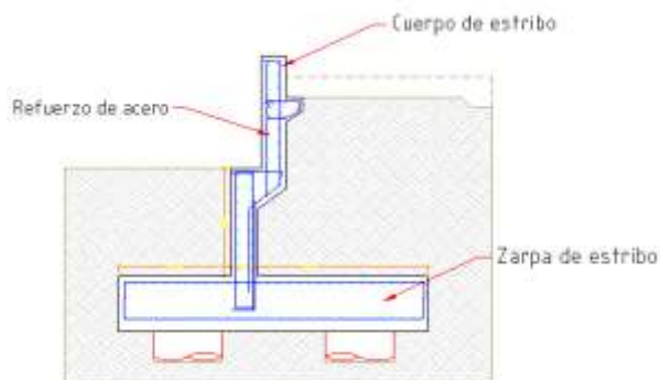
Ilustración 7 estribo del puente
