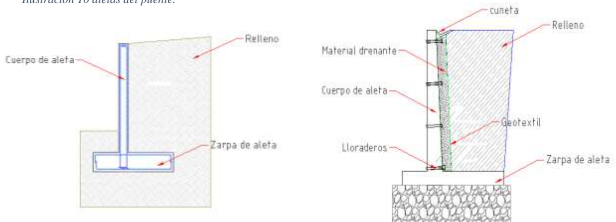
Ilustración 10 aletas del puente.
