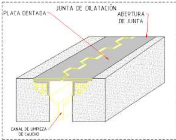
Ilustración 11 otros elementos del puente.
