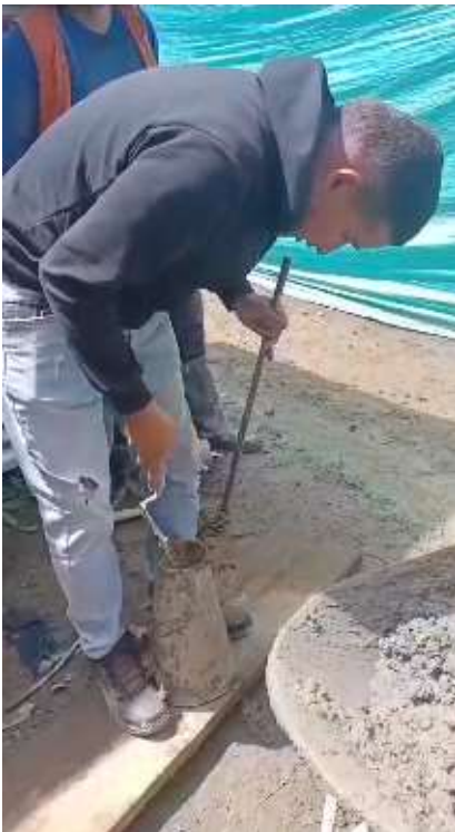
Ilustración 44 ensayo de asentamiento del concreto.
