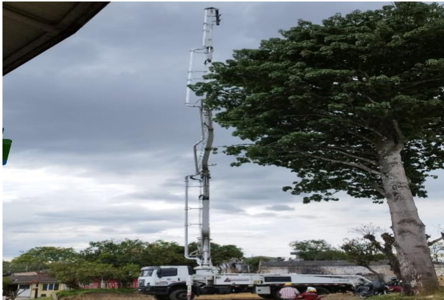
Ilustración 27 Camión bombeador extendido
