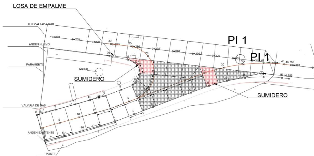
Ilustración 15 Plano de modulación boca calle, calle 5ªA
