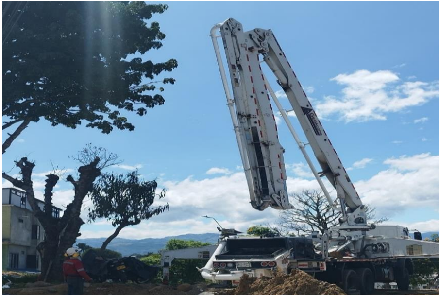
Ilustración 26 Camión bombeador de concreto
