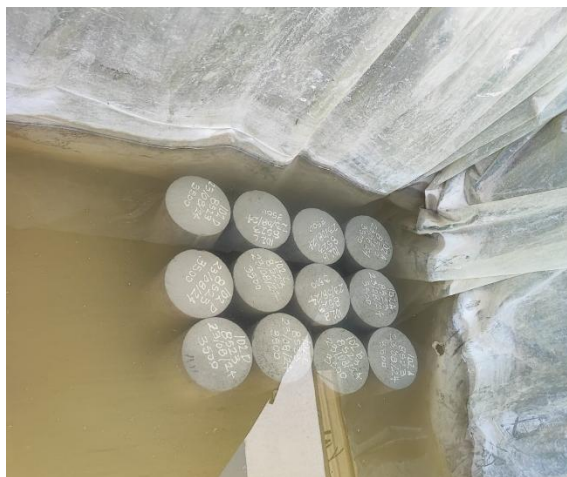
Imagen 37. Lote de cilindros de concreto en inmersión
