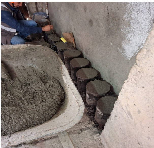
Ilustración 8 Toma de cilindros de prueba del concreto premezclado
