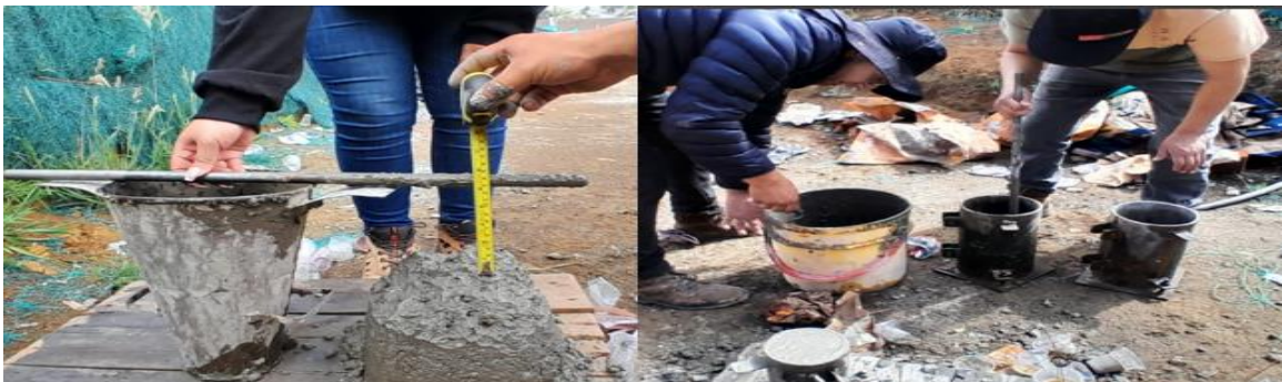
Ilustración 36 Ensayo de Slum, Elaboración de Cilindros Muros Internos.
