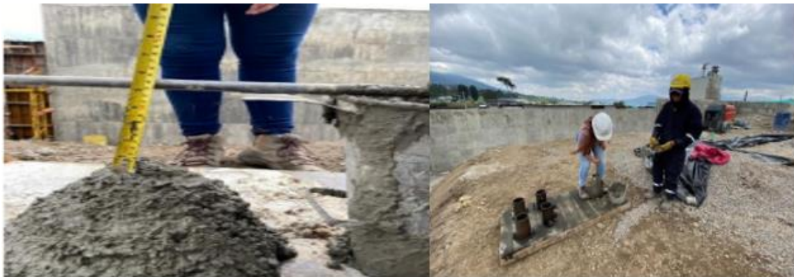
Ilustración 47 Ensayo de Slum, Elaboración de Cilindros Muro M8.
